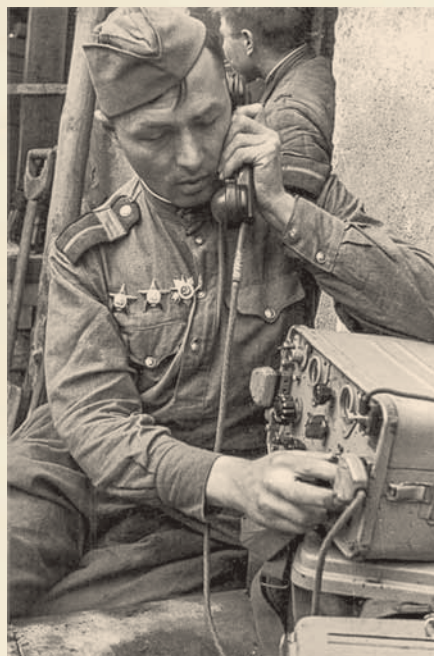
СТАРШИНА РАБОТАЕТ НА ПЕХОТНОЙ РАДИОСТАНЦИИ РБ-М (РАЗРАБОТКА 1936 г., МОДЕРНИЗАЦИЯ В 1942 г.)
