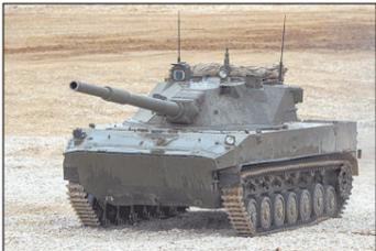
«Спрут» стреляет со скоростью 7 залпов в минуту, а благодаря мощному двигателю пушка может передвигаться со скоростью 70 км в час. Кроме возможности парашютного десантирования, орудие способно самостоятельно плавать со скоростью 10 км в час при волнении до 3 баллов.
