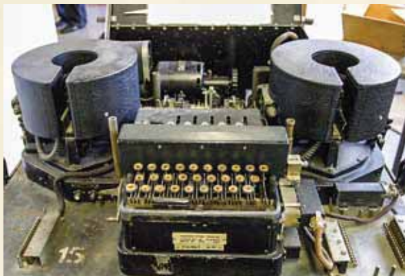
АНГЛИЙСКИЙ ШИФРАТОР ТУРЕХ СОЗДАН НА ОСНОВЕ ЗНАМЕНИТОЙ «ЭНИГМЫ»
